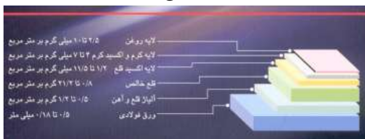
شکل ۴- لایه های تشکیل شده بر روی نیم ورق فولادی پس از قلع اندود شدن
