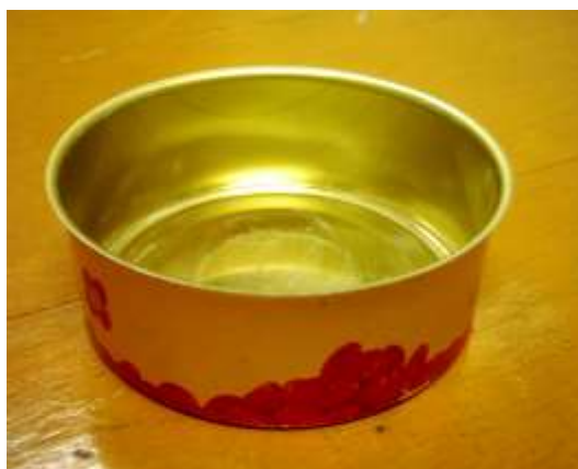
شکل ۱۲- نوعی قوطی تهیه شده به روش کششی که در آن خطوط کشش دیده می شوند
