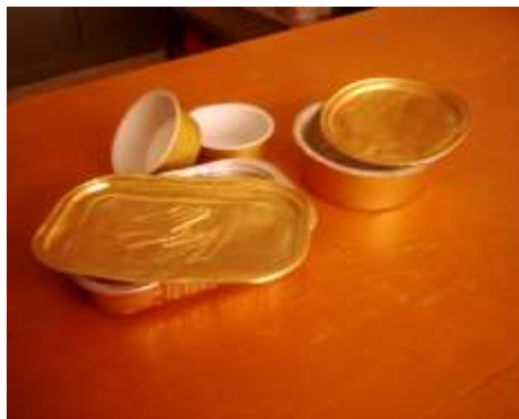
شکل ۸- چند نوع ظرف پرسی آلومینیومی
