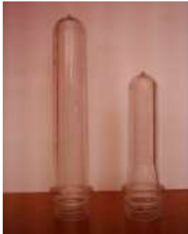
شکل ۲۸- تزریق پلی مر مذاب به درون قالب سرد جهت تولید شکل اولیه و یا ظرف نهایی
