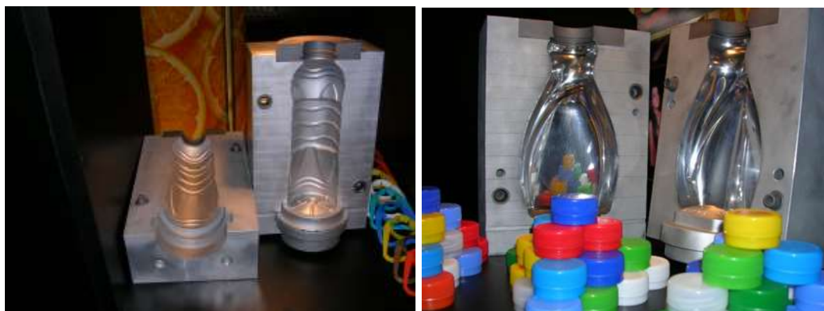
شکل ۸- قالب بطری باز شده
