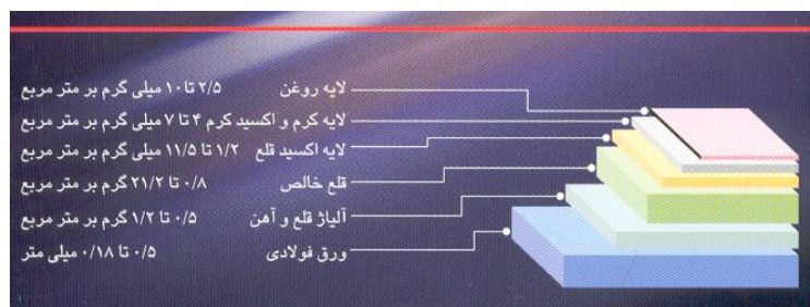
شکل ۴- لایه های تشکیل شده بر روی ورق فولادی پس از قلع اندود شدن
