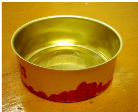
شکل ۱۲- نوعی قوطی تهیه شده به روش کششی و ظهور خطوط کشش بر سطح داخلی قوطی
