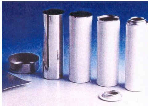
شکل ۱۳ - ساخت بدنه قوطی آئروسول به روش کششی عمیق.
